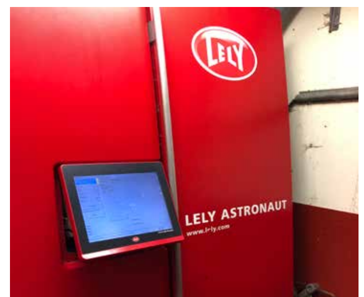
Datamaskinen registrerer hvor mye melk som kua leverer og når den er brunstig.
